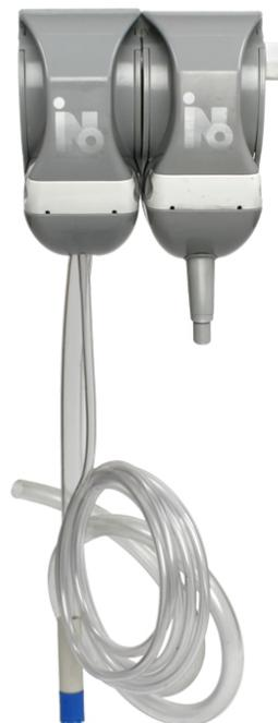
Plus aucun problème d'embout de doseur bouché avec le proportionneur révolutionnaire INO jet. Ce problème a été éliminé en faisant appel à un système contrôlant la dilution chimique par le biais d'une goulotte au lieu d'un orifice. La goulotte peut être aisément nettoyée et on en retrouve quatre par embout pour une dilution facilement ajustable.
